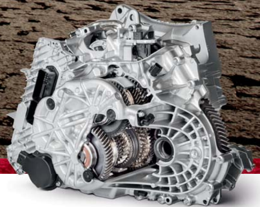
GETRAG 7DCT300 Transmission
