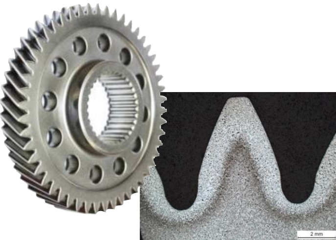
图3. 螺旋齿轮 - 齿形上的低压渗碳分布
