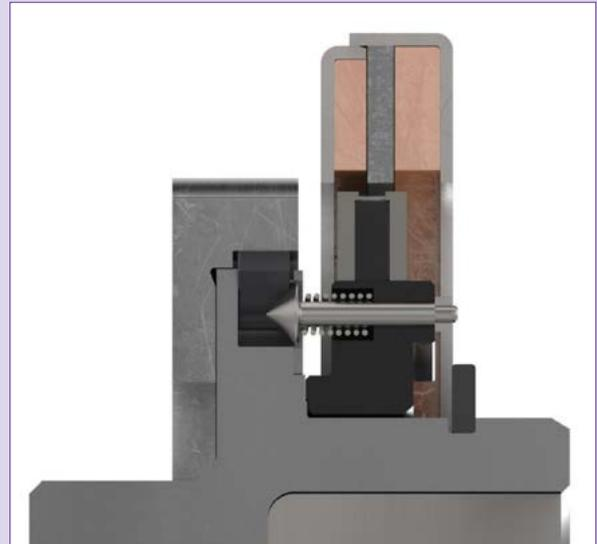
图4：DCC线性电机位置
